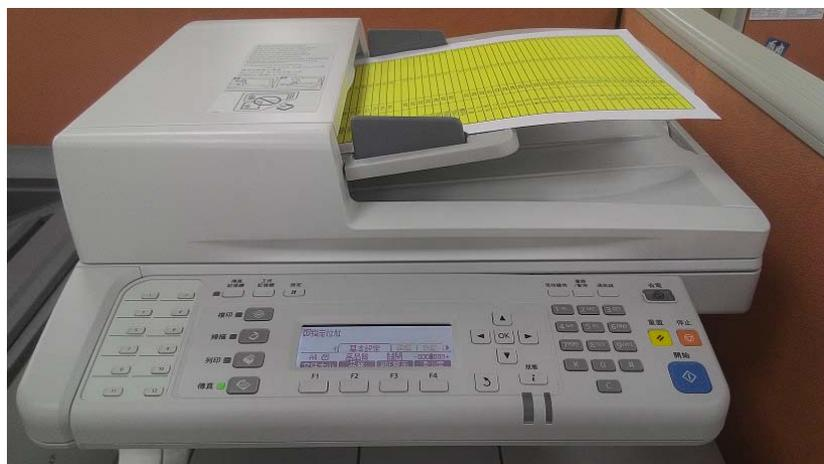
3-2：在液晶面板的左側，按下「掃描」功能鍵，此時「掃描」功能燈會亮起，液晶面板顯示：指定掃描位址時，按下方「F2」鍵，選擇「資料夾」。
